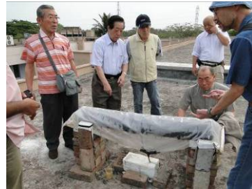
本学が開発した太陽熱淡水化装置の性能実験の様子
